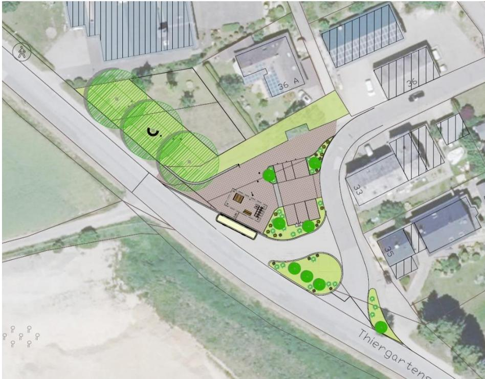
In der **Variante 1** ist im mittleren Teil eine Busstraße angelegt, ohne die Möglichkeit, dass der reguläre Straßenverkehr diese Fläche nutzt. Der weitere Straßenverkehr soll südlich der Fläche abgelenkt werden, die gleichzeitig auch als Buswendeplatz dient. Diese Variante verbessert die Sicherheit der
